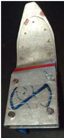
Самодельный носок для срочного ремонта
